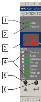
Рисунок 1 – Органы индикации и управления преобразователей
