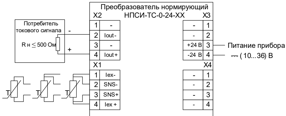
Рисунок 5 – Электрическая схема подключения преобразователей НПСИ-ТС-0-24-Х для всех версий
